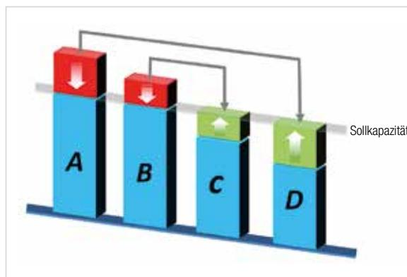
Die Toshiba „IFT“ Technologie sorgt für die Umverteilung von Überkapazitäten, damit in der gesamten Anlage eine optimale Leistung und Effizienz gewährleistet ist.
