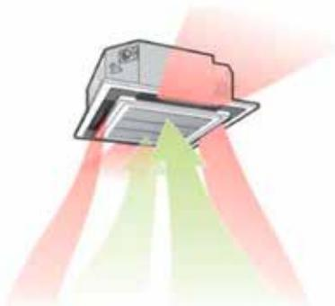
Die nebeneinanderliegenden Lamellen wechseln alternierend die Luftrichtung nach oben oder unten.
