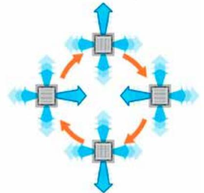
Die Lamellen der vier Geräte bewegen sich in verschiedenen Zeitintervallen und ermöglichen eine optimal abgestimmte Luftverteilung im ganzen Raum.
