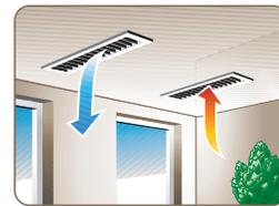
In einer bestehenden Zwischendecke wird die Raumluft unten am Klimagerät angesaugt, klimatisiert und dann über Luftkanäle und einen Diffusor wieder zurück in den Raum geblasen.
