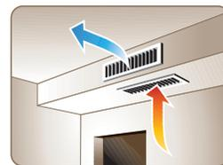
Falls noch keine Zwischendecke zur Verfügung steht, kann mit einer abgesenkten Decke auf nur einer Seite des Raumes eine nahezu unsichtbare Klimatisierung erreicht werden.
